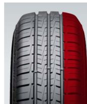
L'épaulement extérieur renforcé et les nervures centrales continues garantissent une excellente tenue de route et une grande résistance aux chocs dans diverses conditions de circulation.
